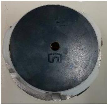
図-13 拘束のためのプレートの外観
