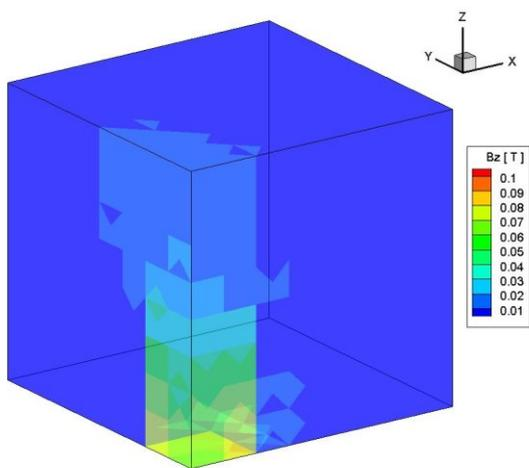
図-6(a) 磁束密度ベクトルの  $z$  方向成分の分布図
