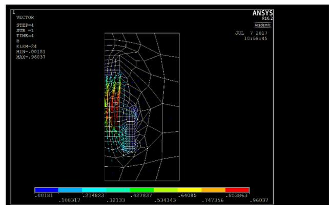
図-1 ANSYSによる磁場解析結果の一例
