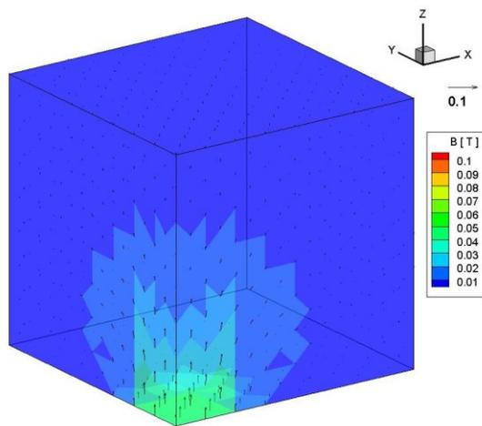
図-4(b) 磁束密度ベクトルの分布図
