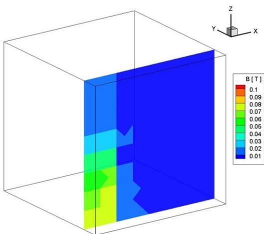
図-5(a)  $y=25\text{mm}$  断面における磁束密度ベクトルの分布図 (クーロンゲージの仮定をしない場合)
