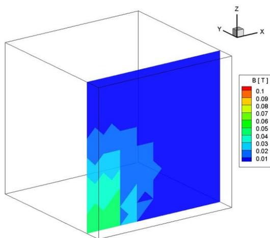
図-5(b)  $y=25\text{mm}$  断面における磁束密度ベクトルの分布図 (クーロンゲージの仮定をした場合)
