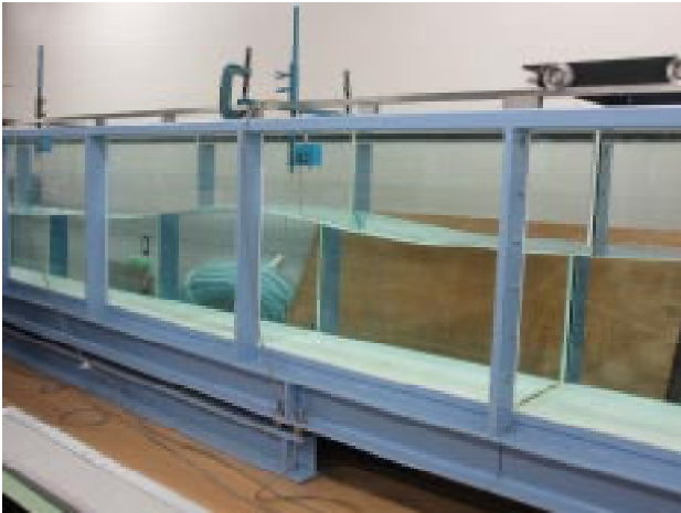
図-1 波動水槽を使用した水位計測の様子
