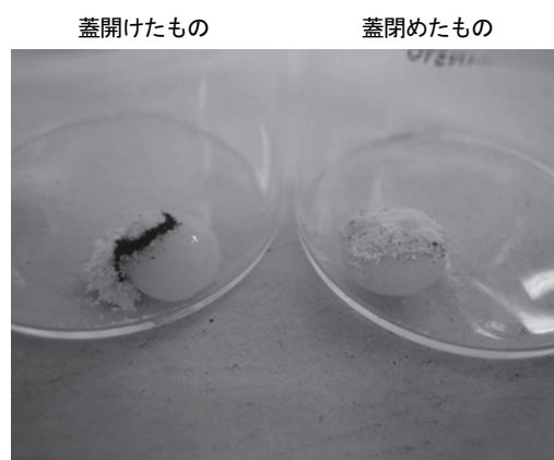
図-6 硫酸銅無水和物との反応
