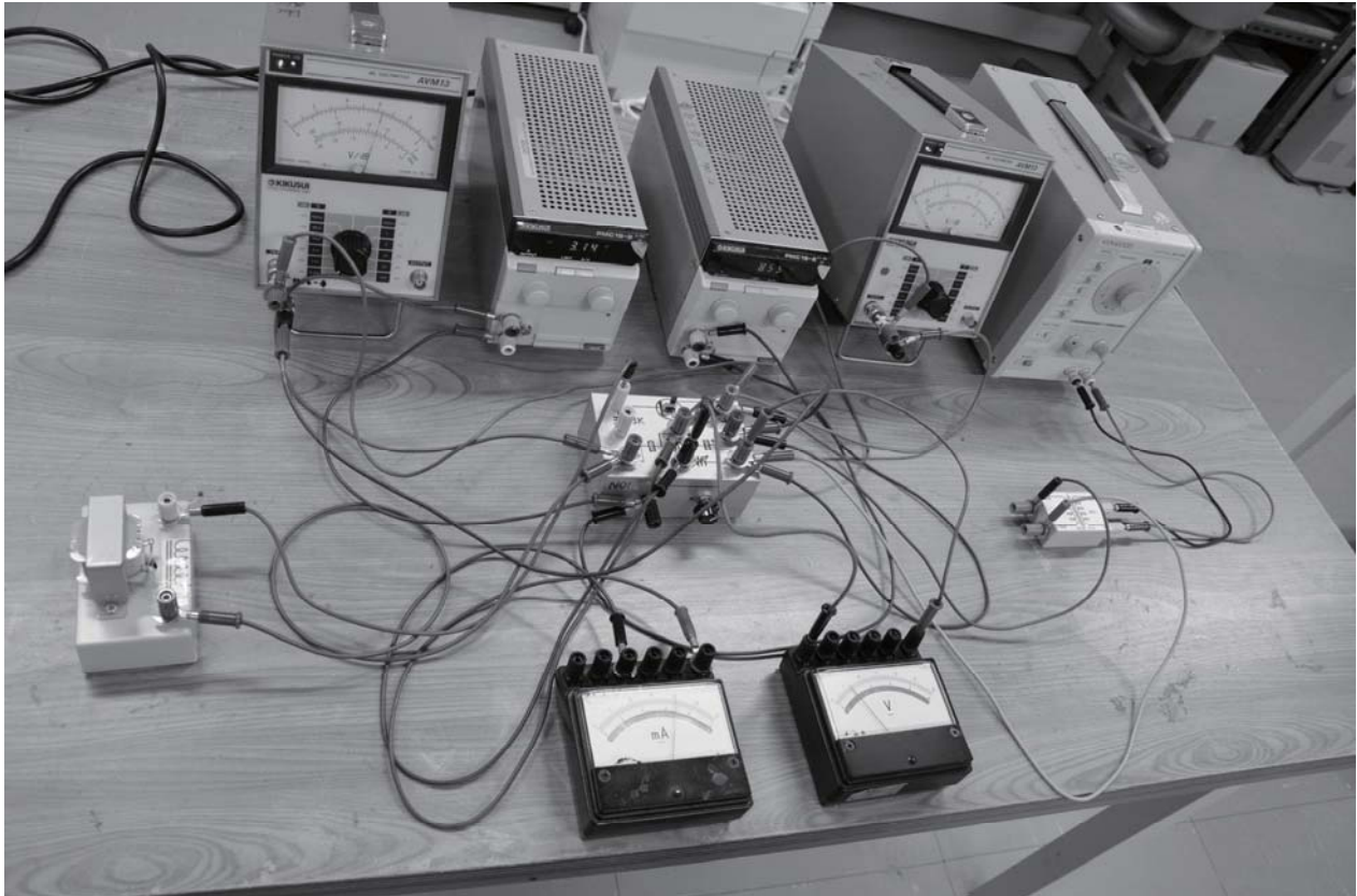
写真-1 2SC1815 (Y) の hoe 測定時の配置と配線の例
